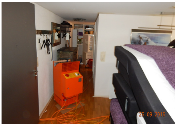
Abb. 2. Wärmeentwesungsofen im Einsatz (Foto: Konsag, M. Wyss)
